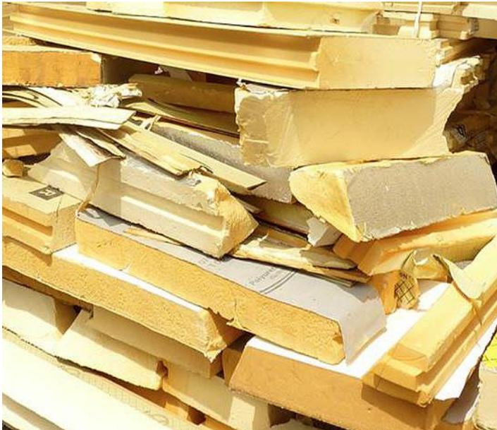
Dämmstoffabfälle aus PU-Hartschaum - erkennbar an der gelb-bräunlichen Farbe und leicht „sandigen“ Oberfläche.
